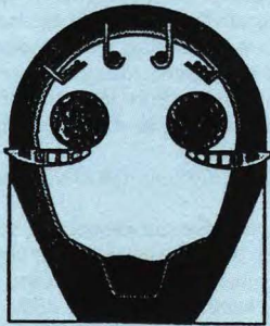
Colector de una galería de servicio parisina (s. XIX). En su interior se colocaban servicios de telefonía, agua y calefacción.
